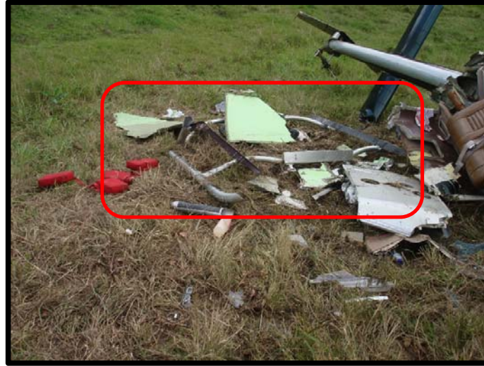
Fotografía No. 5 TREN DE ATERRIZAJE DESPRENDIDO.
