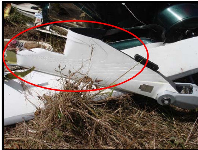
Fotografía No. 12 Daños en Rotor Principal.
