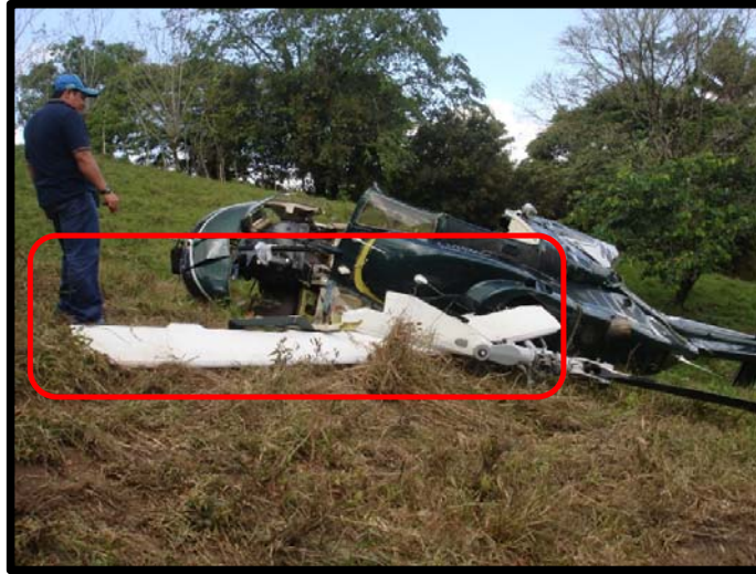
Fotografía No. 11 Rotor Principal quebrado.
