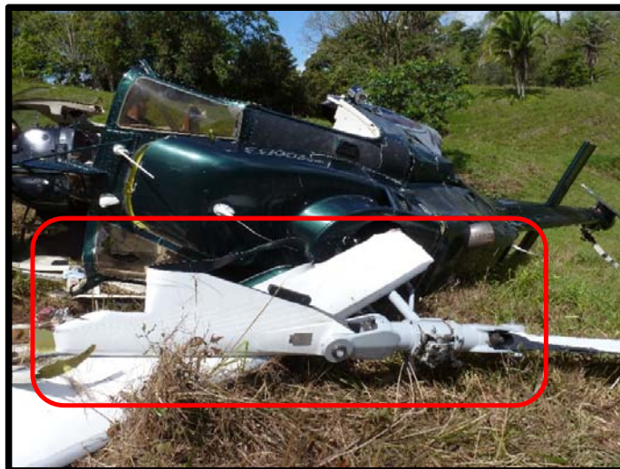
Fotografía No. 8 Daños en el Rotor de Cola.
