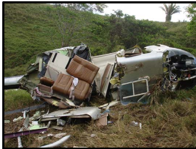
Fotografía No. 6 Vista inferior de daños en la cabina.
